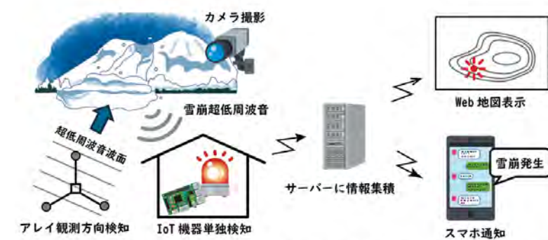
超低周波音を使った雪崩検知・通報システム概念図
